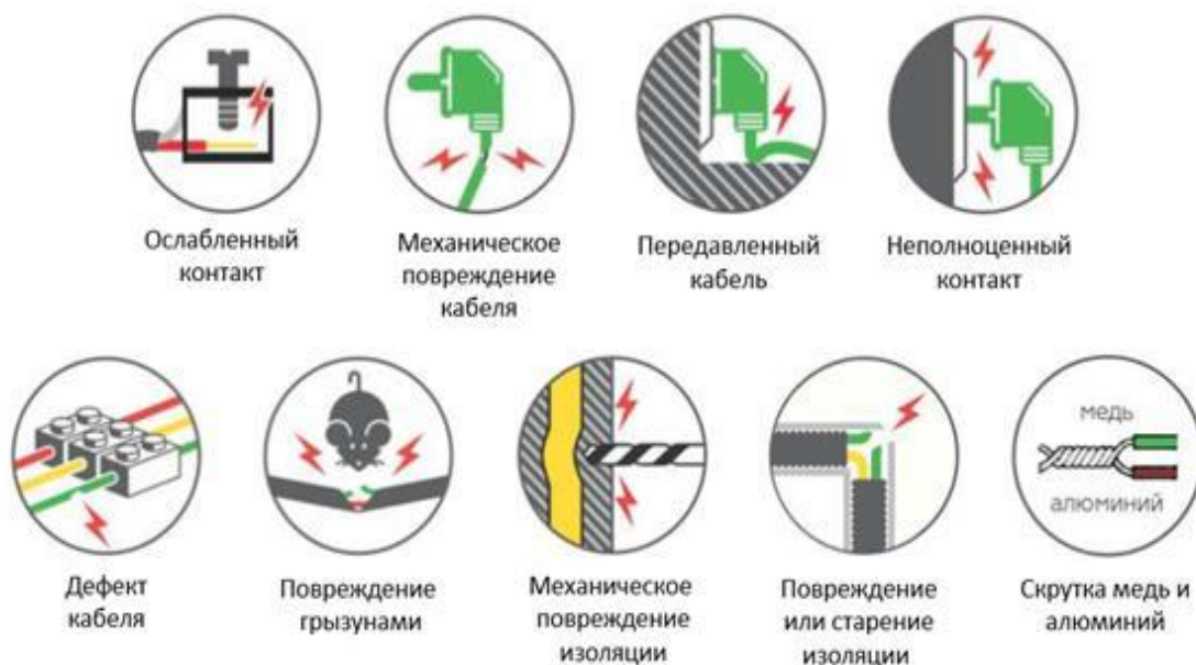
Рисунок 6. Возможные причины искрения в электропроводке
